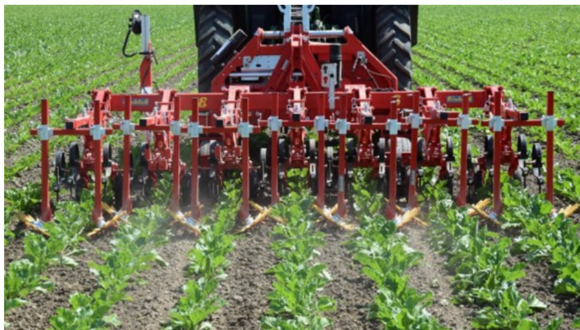
Fig.4 Prașitul de precizie cu senzori și ghidaj între plante și între rânduri
